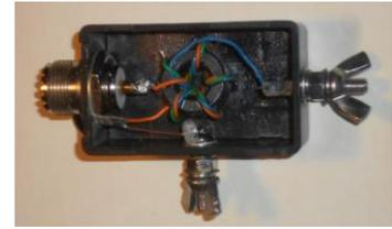
Ich kontrollierte alle Anschlüsse und Verbindungen, den 1:9 Balun (UNUN) geöffnet und überprüft, ohne sichtbare Defekte oder Mängel. Ich sagte mir schon: Funkurlaub ade!
