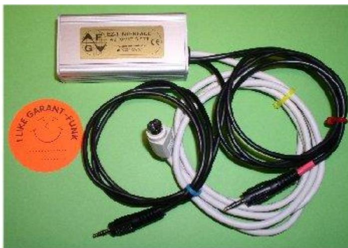
Man benötigt keinerlei Installation oder Einrichtung am PC, die drei Stecker einstecken (DATA-Buchse am Transceiver, Mikrofon- und Kopfhörerbuchse am PC) und fertig!
