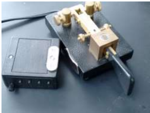
Abbildung 1: Am Ultra PicoKeyer befestigte Magnet-Gegenplatte. Der Magnet selbst "klebt" am eisernen Sockel des Paddle
