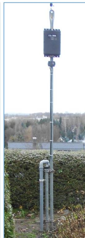
Hinweis: Der Tuner wurde mit der vorgesehenen Anschlussmöglichkeit nicht mit GND verbunden. Hintergrund: Die Zuleitung zum TRX erfolgt über das beschriebene unterirdisch verlegte Koaxialkabel. Dieses stellt das Gegengewicht dar.
